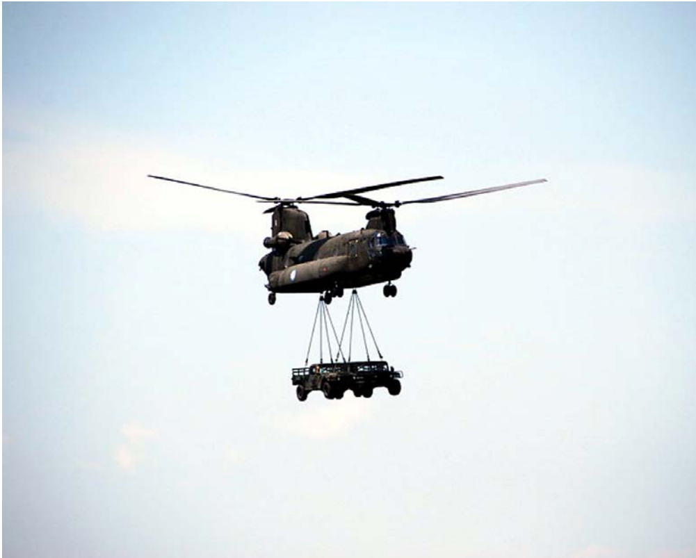
Φωτ. Μεταφορά οχημάτων ως εξωτερικό φορτίο σε Ε/Π CH-47D
