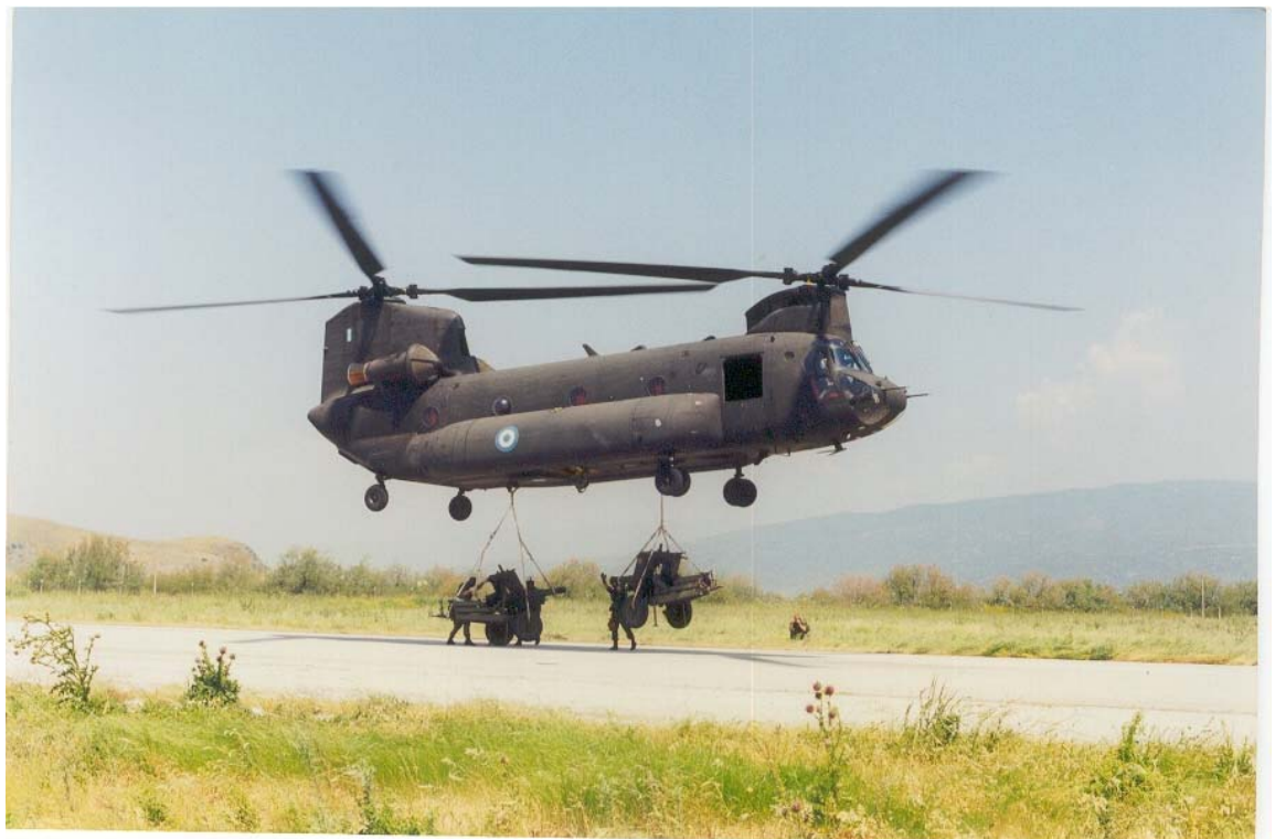
Φωτ. Ανάρτηση πυροβόλων ως εξωτερικό φορτίο σε Ε/Π CH-47D
